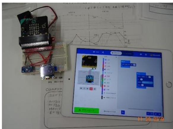
図1 気温・湿度・気圧を表示する気象観測システム
