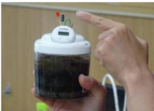
写真 16 : MadWatt の LED の点滅の様子
