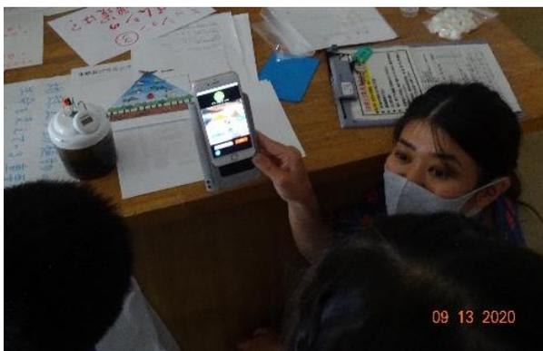
写真 17: 田んぼの土を入れた MadWatt の発電量をアプリで計測する様子
